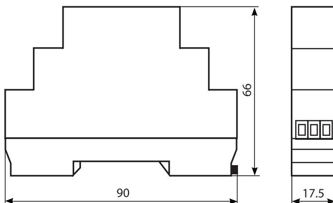
Внимание! Фотореле ФР-9М является устройством управления и не предназначено для непосредственной коммутации мощных осветительных приборов. Суммарная мощность осветительных приборов должна быть менее 1кВт. При использовании осветительных приборов с суммарной мощностью более 1кВт рекомендуется применять промежуточные реле, магнитные пускатели либо контакторы, рассчитанные на соответствующую нагрузку.
