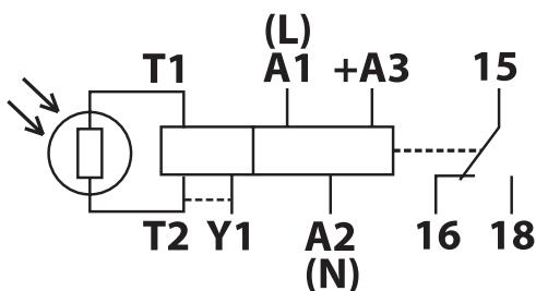
Напряжение питания 24В подается на клеммы «+A3», «A2». При питании реле постоянным напряжением «+Упит» подключать на клемму «+A3». Напряжение питания 220В 50Гц подается на клеммы «A1», «A2». Фазный провод обязательно подключается к клемме «A1» («L»), а нулевой - к клемме «A2» («N»).
