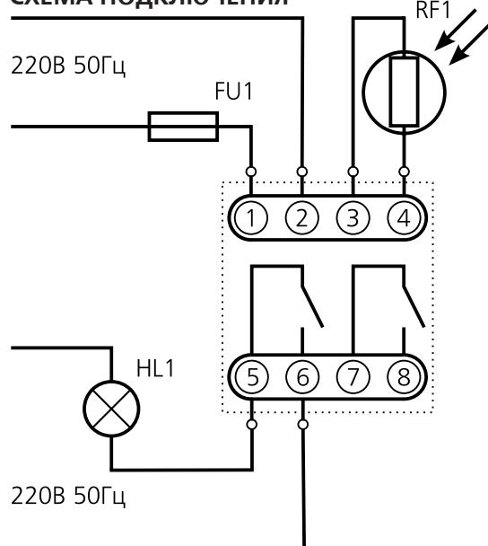
Рекомендуемая схема включения фотореле при мощности нагрузки до 300Вт
